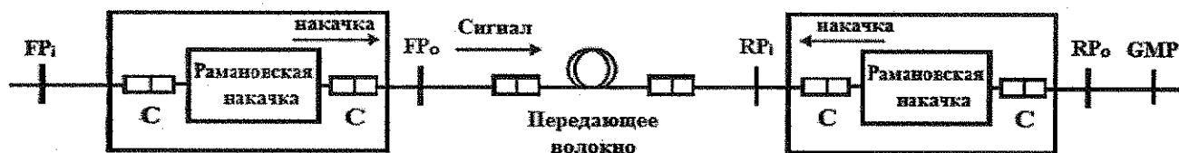
Рисунок 3 – Рамановский усилитель с двусторонней накачкой
